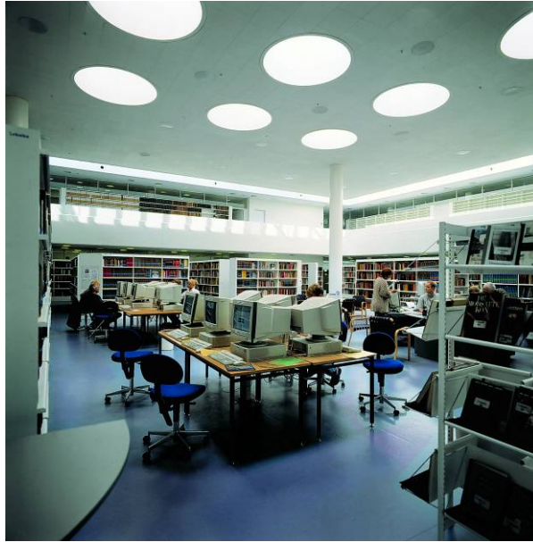
Figur 4. Gentofte Bibliotek. Bygninger med store, dybe rum kan være vanskelige at forsyne med tilstrækkeligt dagslys i midten. Løsningen kan være at anvende almindelige vinduer i facaden suppleret med ovenlys. Foto: Morten Kjærgaard.
