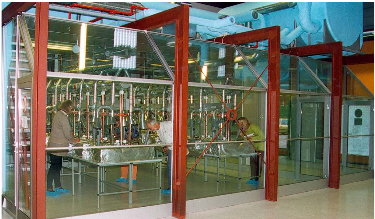
Figur 4. Personer bedømmer kvaliteten af luft, der er forurennet med afgasninger fra materialer i luftkvalitetslaboratoriet på SBI.
