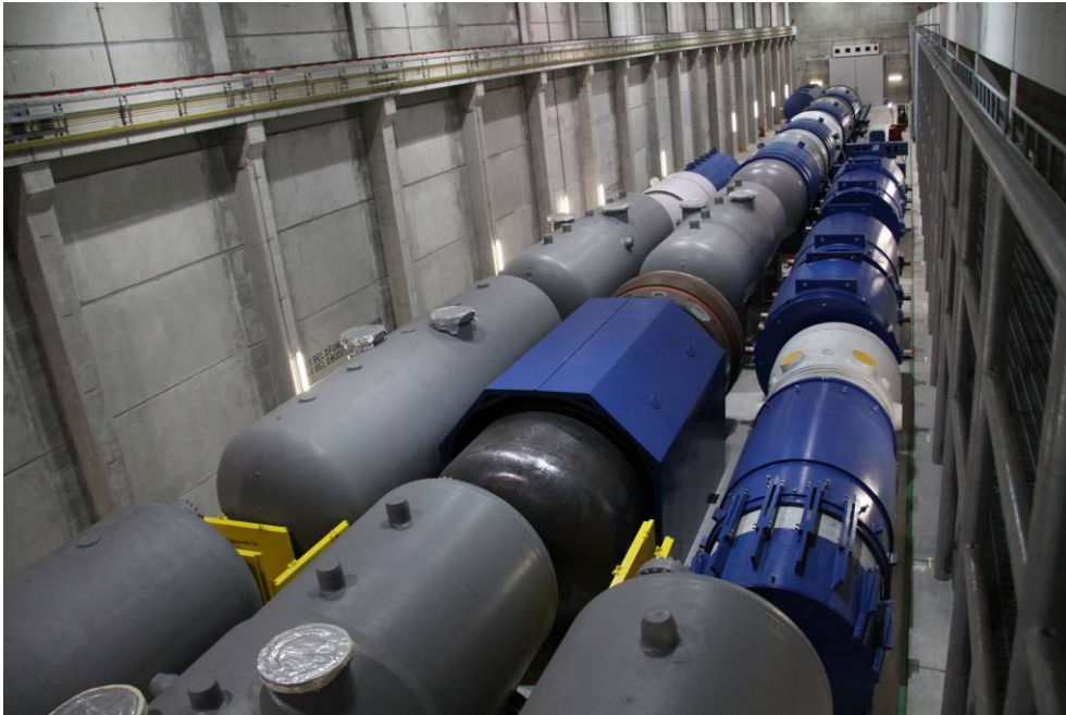
Figur 3.4. Udtjente dampgeneratorer i hal 7.
