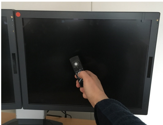
Måling af belysningsstyrke i monitorens centrum med Illuminansmåler
